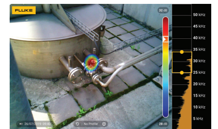
Únik plynu na špatně těsnícím ventilu potrubí
