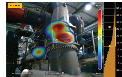
Barevná mapa zobrazující vibraci potrubí
